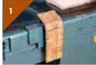
1 Bei verzogenen Werkstücken hohle (linke) Seite auf den Aufgabebisch legen.
