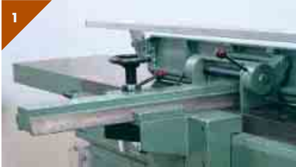
1 Anschlagführung ist gleichzeitig Messerwellenverdeckung
