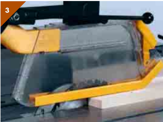
3 Schutzhaube auf Werkstückdicke einstellen oder auf den Maschinentisch absenken.
